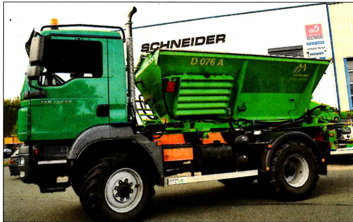
Dank Wechselsystem sind verschiedene Aufbauten möglich.
